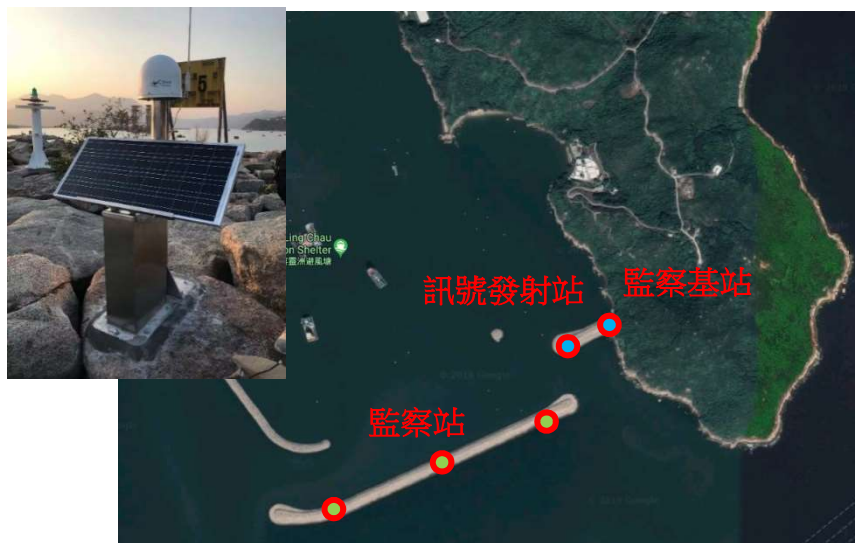
▲ 第一階段試驗 - 北斗衛星位移監察站
