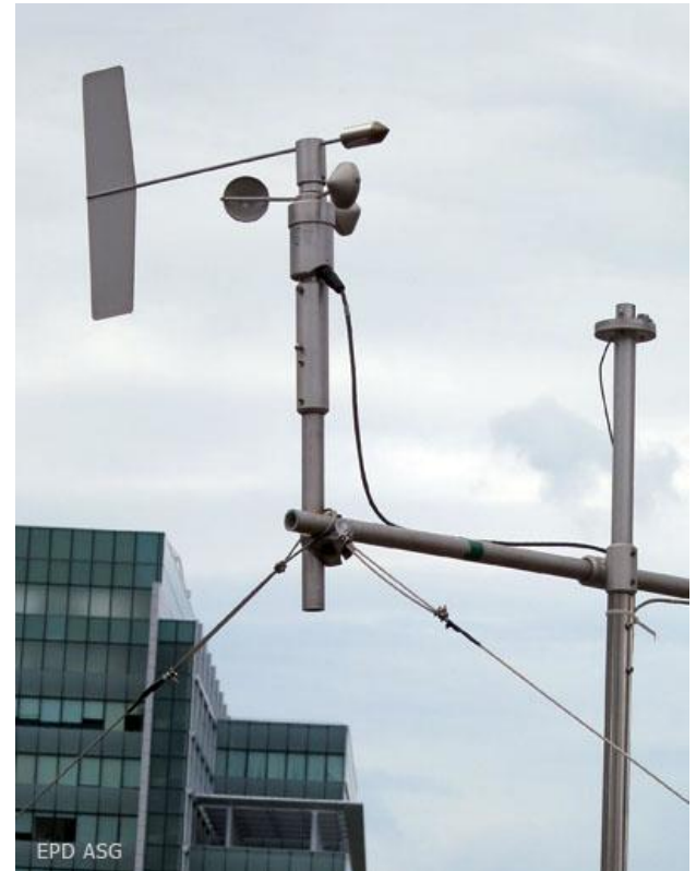
實地風速及風向監測儀器
