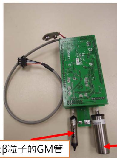
測量 $\gamma$ 射線的GM管
