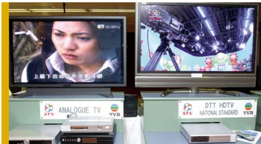
▲ 使用模擬制式的電視畫面(左圖)，影像明顯出現「鬼影」，而利用數碼訊號的高清電視影像(右圖)則極為清晰。
