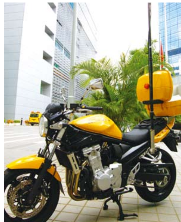
▲ MCCTV系統由4個部分組成，包括流動監察中心、監察系統運載、戶外流動鏡頭組件和影像接收組件。圖為運載監察系統的電單車。
