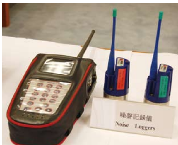
▲ 水務署利用「噪聲記錄儀」紀錄及分析水管滲漏的訊號，讓水管測漏人員初步判定水管滲漏的位置。
